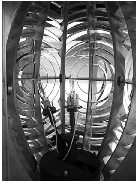
Óptica con lámparas halógenas de Mesa Roldán. Foto Mario Sanz
