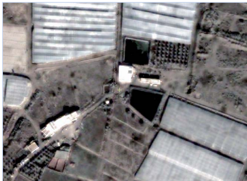
Detalle de fusión de una ortoimagen multiespectral de QuickBird (2.5 m de tamaño de píxel) con una ortoimagen pancromática del mismo satélite (0.6 m de tamaño de píxel)
