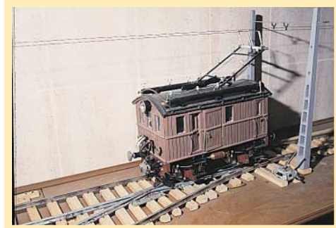
Reproducción artesanal de los motores trifásicos que funcionaron en las duras rampas de la línea entre 1911 y 1965.
