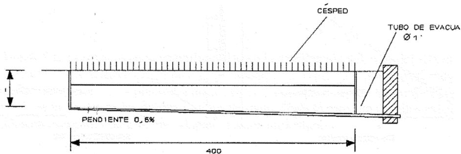
Figura 4.- Sección longitudinal del lisímetro de drenaje (cotas en cm.).
