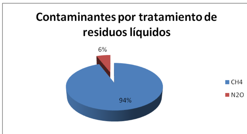
Figura 6. % de contaminantes producidos por tratamiento de residuos líquidos, en Almería año 2005. Fuente: Elaboración propia, a partir de datos de Consejería de Medioambiente 2008
