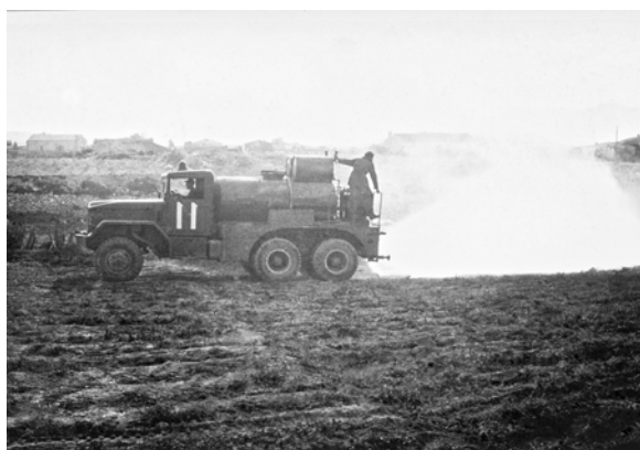
Regado de tierras contaminadas para evitar la resuspensión de polvo radiactivo. El de la foto lleva incorporados dos barriles con gasoil para mezclar con el agua y fijar con más eficiencia la contaminación. (Foto: AHEA).
