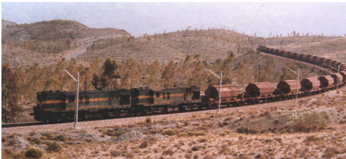
Tren cargado de mineral de hierro con una larga composición en cuádruple tracción por cola entre las estaciones de Doña María-Ocaña y Nacimiento. Las líneas ferroviarias de Almería se caracterizaron por el intenso transporte de minerales desde el interior a la costa y condicionaron el desarrollo del transporte ferroviario en la provincia. Fondo ASAFAL, década de 1980.
