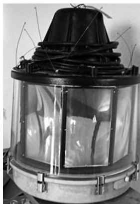
Nueva óptica acrílica para el faro del Castillo de San Telmo. Foto Mario Sanz
